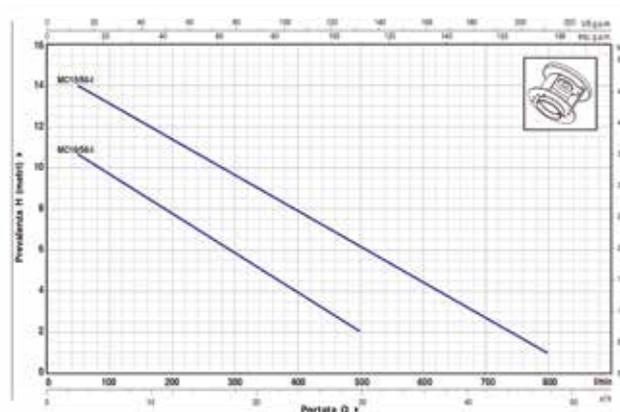
CURVE E DATI DI PRESTAZIONE 50 Hz n=2900 1/min
